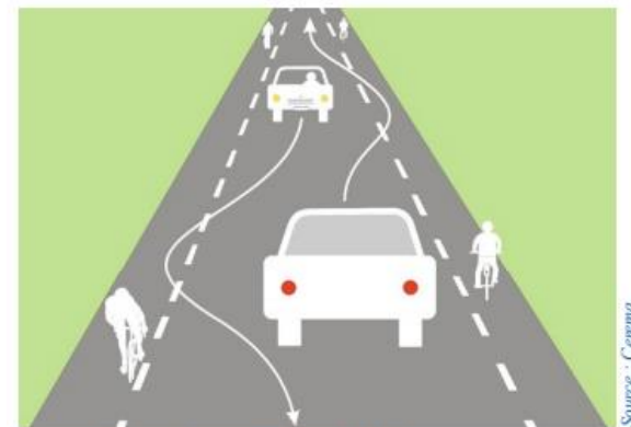
Principe de fonctionnement d'une CVCB
